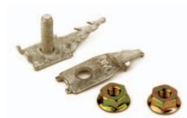
Der Schirmverbinder 4460-D ist die kleinere Variante des 4460-S. Er ist die erste Wahl für Kabel mit bis zu 100 DA oder 20 mm Außendurchmesser. Seine Stromtragfähigkeit ist höher als die des Alu-Schirms eines solchen Kabels.
