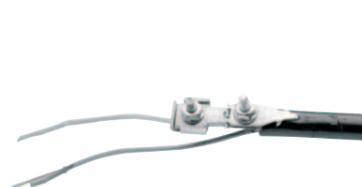
Der Schirmverbinder 4460-D/FO ist speziell entwickelt für Glasfaserkabel, die Zugentlastungselemente aus Metall oder Fiberglas enthalten. Im Vergleich zum 4460-D bietet er zwei zusätzliche Platten, um die Zugentlastungselemente aufzunehmen und zu sichern.
