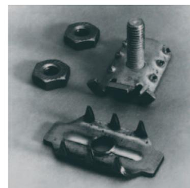
Der Schirmverbinder 4462 ermöglicht eine stabile, niederohmige elektrische Verbindung zwischen dem Schirm eines Kabels und einem Leiter, wie z. B. einem Draht, einer Schiene oder einem Band.
